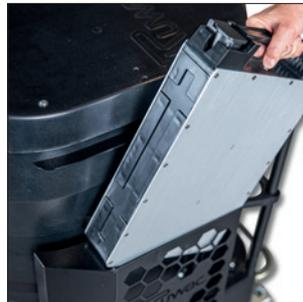
Direktes Einsetzen des neuen Akkus
